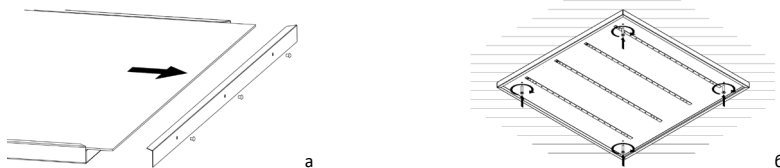
Рисунок 5 — Накладной монтаж светильника Geniled серии Офис, ЛПО.
